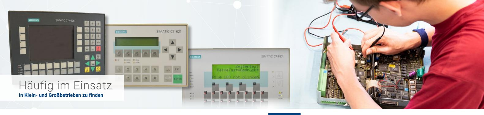
Ein SIMATIC® C7 Gerät setzt sich standardmäßig aus den Einzelkomponenten CPU und Touch Panel bzw. Operator Panel zusammen. Diese arbeiten unabhängig voneinander. Jeder der Prozessoren ist einem eigenen Speicher zugeteilt. Ein-/Ausgabebausteine sowie digitale und analoge Schnittstellen finden sich ebenfalls in einem C7.
