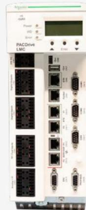
Bei der Serie Lexium® des Herstellers Schneider handelt es sich um Technik für Positionier- und Synchronaufgaben. Es ermöglicht die Synchronisierung von bis zu 130 Servoachsen/ Robotern.
