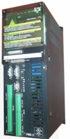
Bei der Serie PacDrive® S des Herstellers Elau handelt es sich um Technik für Positionier- und Synchronaufgaben. Im PMC-2 sind flexible Positioniersteuerung und Motorcontroller in einem Gehäuse (Motion-, Steuer- und Leistungsteil) vereint und das erspart den separaten Motorcontroller für die Servo-Positionierung. Diese Technik wird seit vielen Jahren beispielsweise in der Verpackungs-, Druck- und Textilindustrie eingesetzt.
